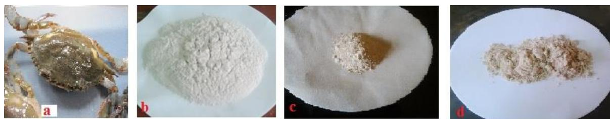
Fig. 1: (a) Crab Shell (b) Pulverized crab shell (c) Chitin (d) Chitosan
